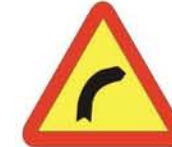
TP-13 a CURVA PELIGROSA HACIA LA DERECHA
