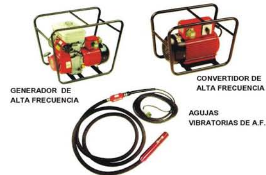
CONVERTIDORES DE FRECUENCIA
