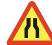
TP-17 ESTRECHAMIENTO DE CALZADA
